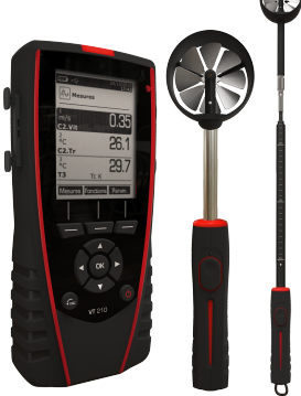
VT210 + SH70 프로브 (Ø70mm 베인 프로브) VT210 + SHT70 프로브 (Ø70 mm 텔레스코픽 베인 프로브)
